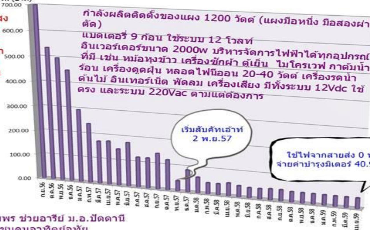
ค่าไฟฟ้าจากการทดลองติดตั้งแผงโซลาร์เซลล์ ครบรอบ 29 เดือนหลังการติดตั้ง ณ พ.ย.2556 - เม.ย.2559
